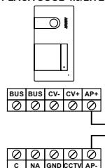
**Note:** Instalación con 2 placas de acceso y pulsador AP en ambas placas, una de las placas debe conectarse el abrepuertas de alterna (ver ejemplo arriba).
