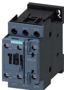
Contactor de potencia, AC-3 12 A, 5,5 kW/400 V 1 NA + 1 NC, 24 V AC, 50/60 Hz 3 polos, tamaño S0 conexión por tornillo
