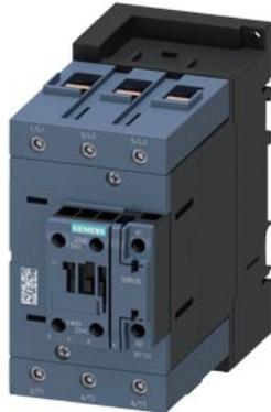
Contactor de potencia, AC-3 110 A, 55 kW/400 V 1 NA + 1 NC, 230 V AC, 50/60 Hz 3 polos, 3S, tamaño S3 borne de tornillo
