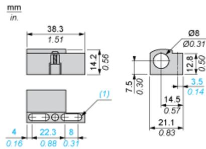
(1) 2 orificios alargados de  $\text{Ø} 4 \times 8 \text{ mm}$  ( $0.16 \times 0.31 \text{ in}$ )
