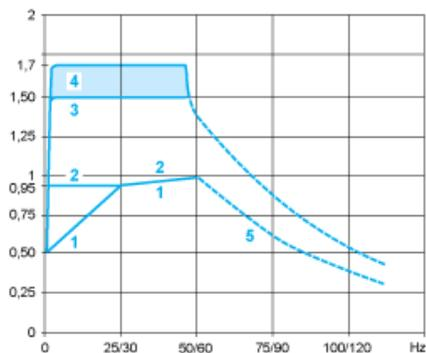
1: Motor autoventilado: par útil continuo (1)
