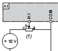
(1) Potenciómetro de referencia de 2,2 k $\Omega$  a 10 k $\Omega$
