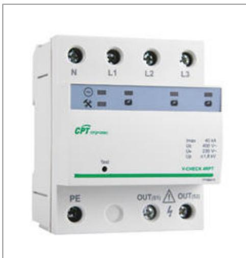
Protector combinado DPS+POP contra sobretensiones transitorias y permanentes, actúa s/bobina de emisión en interruptores de caja moldeada MCCB, Tipo 2 / Clase II, 4 polos (4P), 40 kA (8/20), 230 V, con botón de test POP, 4 módulos.
