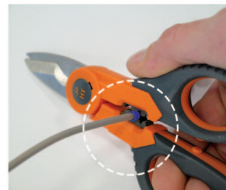
Función crimpadora para terminales desde 1 a 6 mm 2
