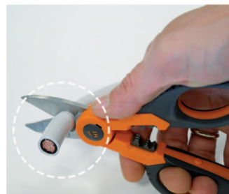
Cuchilla para cortar cable flexible 70 mm 2
