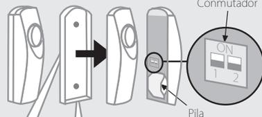
Puede ser instalado en el exterior o en el interior, pero no debe ser instalado sobre una superficie metálica. Puede ser fijado, si se desea, al marco de la puerta o a una pared mediante dos tornillos.
