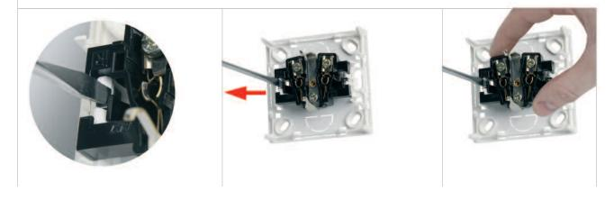
3. Extraer el mecanismo, ejerciendo presión con un destornillador, al tiempo que se tira del mecanismo con la otra mano.
