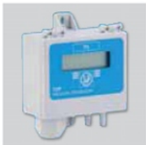
TDP-S / TDP-D Transmisores de presión. Se utilizan para controlar la presión en sistemas de ventilación en presión constante. Permiten la lectura de la diferencia de presiones entre dos puntos y la transforman en una señal eléctrica apta para los diferentes equipos de control.
