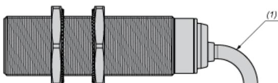
(1) Cable flexible: 4 × diámetro de cable externo
