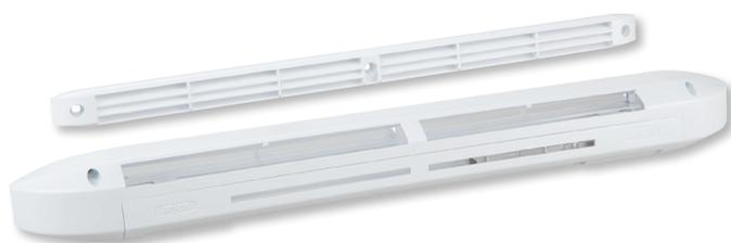
Aireadores higrorregulables acústicos. Fabricados en poliestireno de alto impacto. Permiten la renovación del aire en una vivienda a través de las estancias principales (cuarto de estar, salón, dormitorios). Caudal variable entre 6 y 45 m<sup>3</sup>/h en función del grado de humedad de la estancia, para una diferencia de presión de 20 Pa. Se instalan sobre elementos de carpintería o unidos a un manguito pasamuros.
