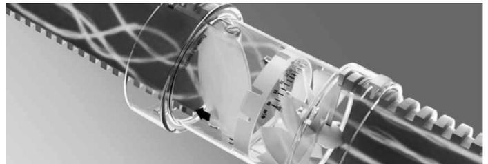
Este elemento permite ajustar el caudal del ramal donde esté instalado de una manera sencilla y rápida. Hasta un máximo de 40 m³/h, sólo aporta 1 PA de pérdida de carga en su apertura máxima. Se recomienda su ubicación donde sea accesible para cualquier actuación posterior. Mediante un destornillador se regula la compuerta hasta obtener el caudal deseado que se visualiza en el indicador incorporado.
