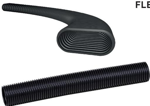
Gama de conductos semiflexibles y accesorios para instalaciones en viviendas unifamiliares y colectivas. Especialmente indicados para instalaciones en falso techo con poco espacio disponible. Combina facilidad de instalación de un conducto flexible y la resistencia de un conducto rígido, evitando que se pueda deformar. Su diseño interno minimiza la pérdida de carga.
